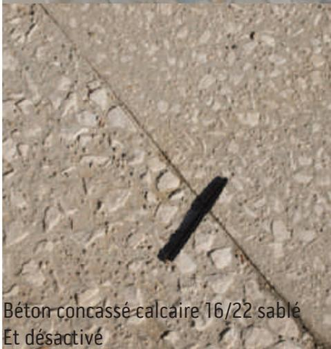
Béton concassé calcaire 16/22 sablé
